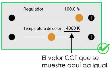
Si el equipo Casambi tiene algo diferente a las interfaces de control que se muestran arriba, es muy probable que no acaben funcionando correctamente con la pantalla SDP-LCD8.
