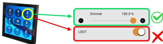
Ejemplo de un equipo que tiene un perfil que tiene un switch que no podría controlar la pantalla
