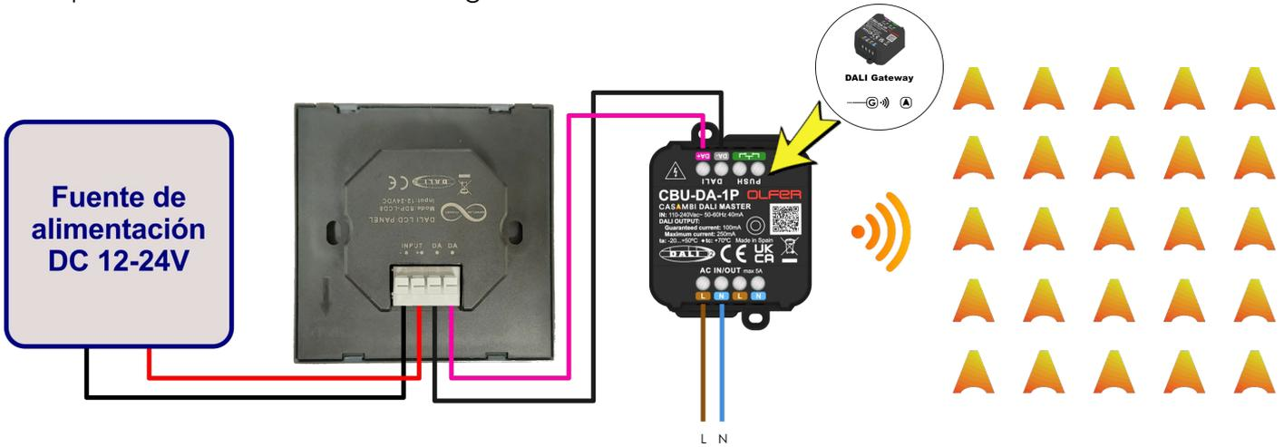
Necesitamos una fuente de alimentación DC con una tensión de salida de entre 12 y 24V que irán a los conectores INPUT de la pantalla, después los conectores DALI irán al CBU-DA-1P.
